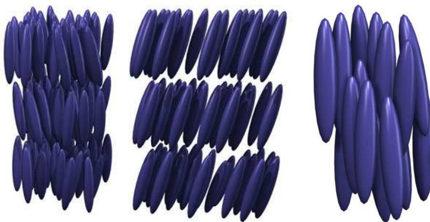
Obr. 2.5: P edstava smectick  A a C (vlevo) a nematick  f ze (vpravo) kapaln ch krystal  [19]
